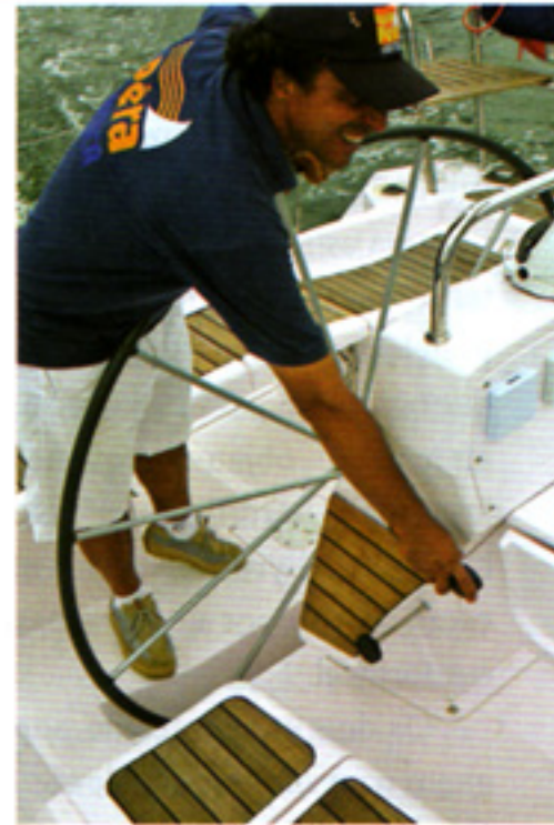
Trilho e carrinho de BB para regulagem da genoa e o único ponto desconfortável que apontamos: posicionamento da manete.
