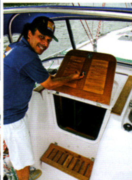
Acima, muito prática a solução da porta de acesso dobrável, que rebate sobre a coberta móvel e desliza junto, para dentro; e sob o piso, na entrada, prático paiol para os cabos.
