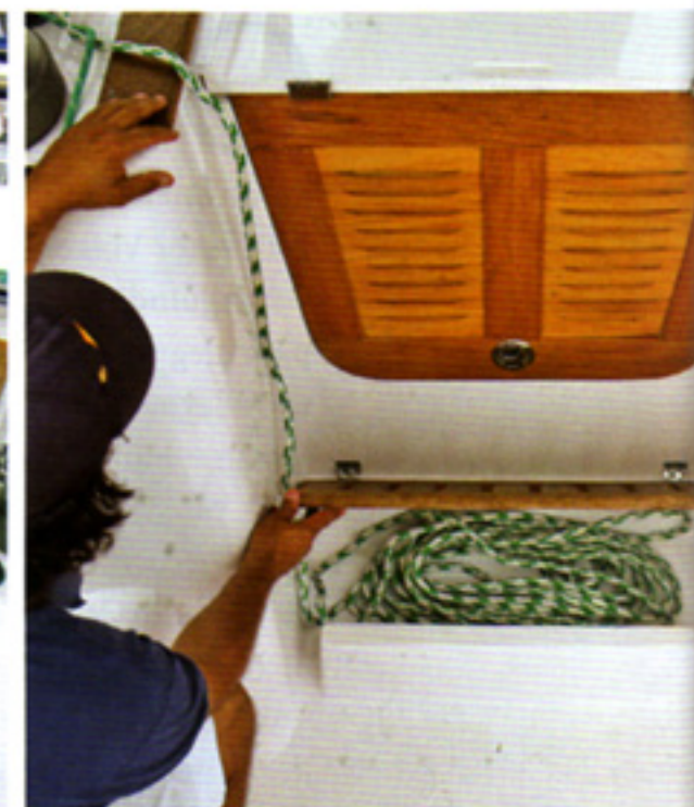
Acima, muito prática a solução da porta de acesso dobrável, que rebate sobre a coberta móvel e desliza junto, para dentro; e sob o piso, na entrada, prático paiol para os cabos.
